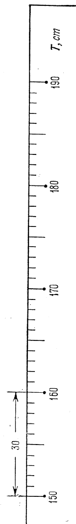
Fig. 37. Canevas de l'échelle métrique de la taille T de module 3 mm entre 150 et 190 cm
