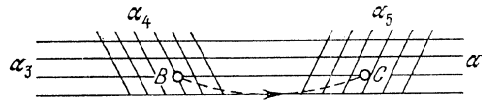
Fig. 204. Schéma de l'abaque à points équidistants pour l'équation f_{12} = f_{34} + f_{35} , déduit de la figure 203 par suppression des familles de droites parallèles attribuées aux variables auxiliaires \alpha , \beta et \gamma
