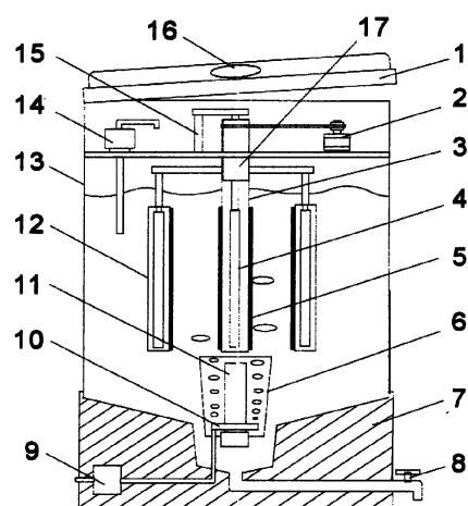
1、一种螺旋藻高效培养器，由培养容器（13）、底座（7）、供气管（10）、气泵（9）、加热器（11）、搅拌器（17）、导流筒（6）和排泄阀（8）等组成，底座（7）位于培养容器（13）的底部，培养容器（13）底部有一开口与设于底座（7）上的排泄阀（8）相通，导流筒（6）设于培养容器（13）的底部开口的中央，加热器（11）设于导流筒（6）的中央，供气管（10）设于导流筒（6）的底部，气泵（9）设于底座（7）内或培养容器（13）的上方，气泵（9）与供气管（10）相连接，其特征在于：所述的搅拌器（17）上设有辅助光源（4）和永久磁条（5）。
