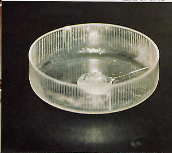
▲試料水をスポイトで取り出し、シャーレに1滴落とし、凍らせている様子 Placing a drop of water to be tested into a Petri dish using a pipette.
