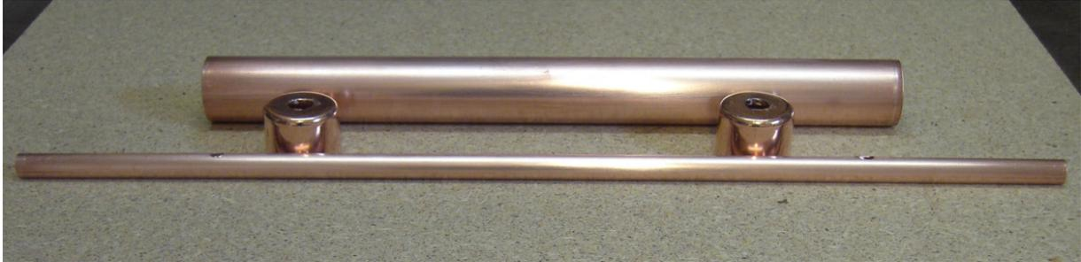
Bohrung für Spulenauslass: senkrecht mit 2,5mm; schräg mit 2,5mm und schräg mit 3,0mm Innen mit 8mm Bohrer entgraten:
