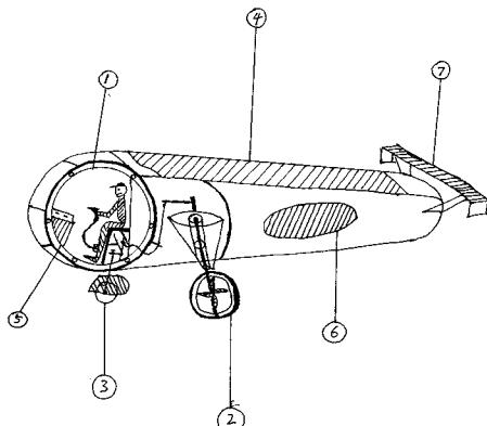
1. 本发明提供了一种新式飞艇 :①艇式薄膜太阳能垂直起降飞艇。该艇由旋转操作仓、转轴（螺旋浆）发动机、轮式缓冲转向翼、薄膜太阳能、锂电池、氦气飘浮仓、尾翼组成。
