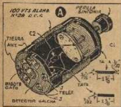
Distribución de los componentes en el receptor a galena
